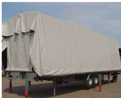
Bâche de toit / Tarpaulin roof
